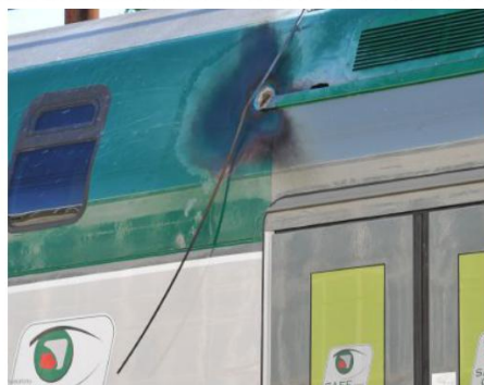
I passeggeri del treno sono tornati a piedi alla stazione camminando sulle traversine. A lato il punto della carrozza su cui è caduto il cavo elettrico che si è tranciato causando scintille e fumo
