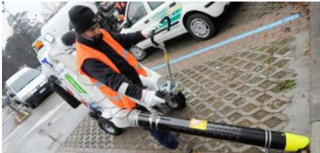
L'altra new entry si chiama Glutton, ed è un aspiratore stradale elettrico per l'aspirazione di ogni tipo di rifiuto che passi da un tubo di 125 millimetri: dalla carta ai mozziconi di sigaretta, dalle foglie sec-
