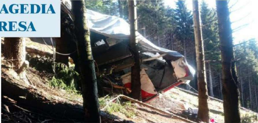
Nele foto, i rottami della cabina della funivia Stresa. **Mottarone precipitata domenica: al centro delle indagini della Procura di Verbania il "forchettonone" che blocca le ganasce dei freni e che sarebbe rimasto aperto per un errore umano: un addetto dell'impianto è stato iscritto nel registro degli indagati**
