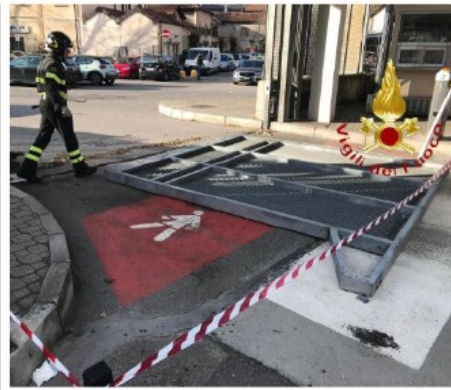
La pesante struttura che è uscita dai binari travolgendo il finanziere
